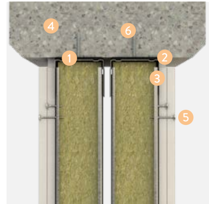
W115.6 Veggtilslutning mot betongdrager
