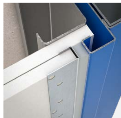
Eksempel på tilslutning av gips mot stålkarm.
