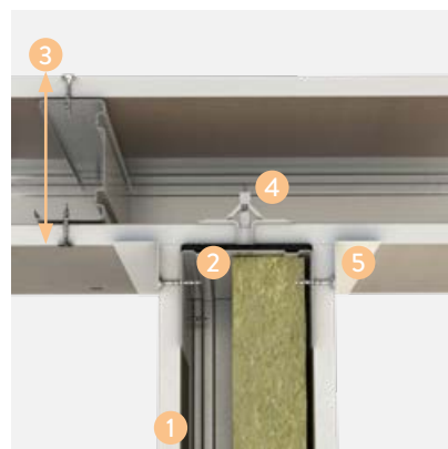
W111.9 Tilslutning mot gipsvegg med plugg
