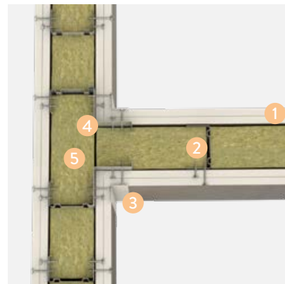
W112.12 Tilslutning mot gipsvegg med stender – A
