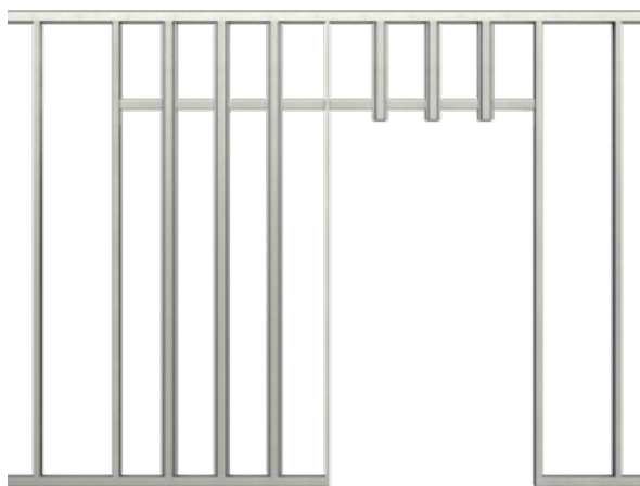
Plassbygd skyvedørsåpning med SW23/85.
