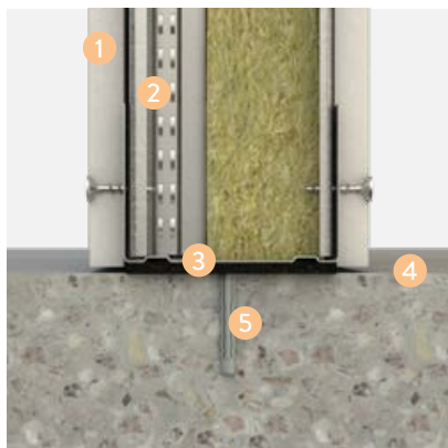
W111.4 Innfestning betonggulv
