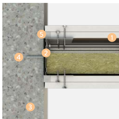
W112.5 Tilslutning mot betongvegg
