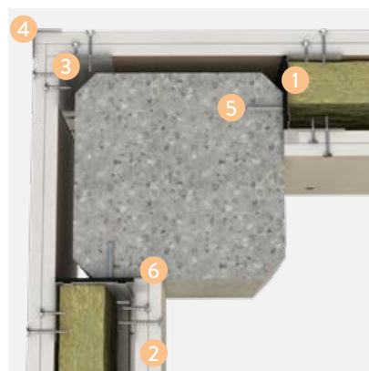
W112.8 Hjørneløsning betongsøyle
