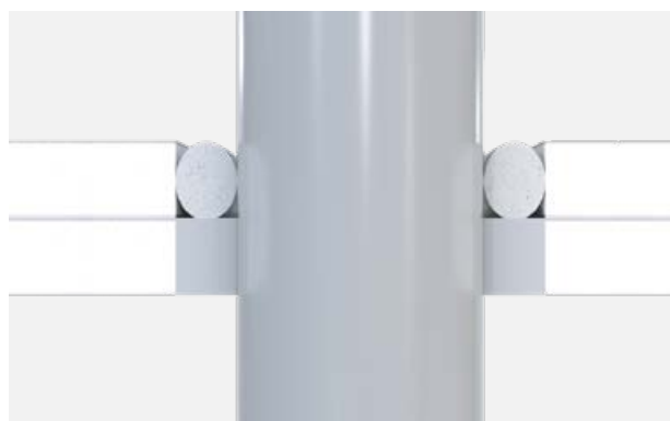
Lydtetting Lydtetting rundt rør med fugemasse.
