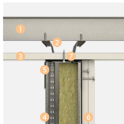
W628B.6 Veggtilslutning mot undertak
