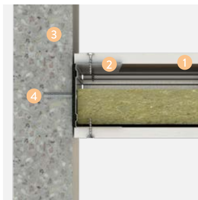
W111.8 Tilslutning mot betongvegg
