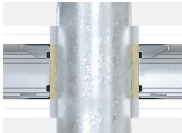
Brannetting av gjennomføringer i brannklassifiserte vegger.
