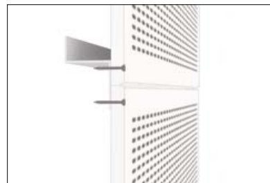
KANT B (AVFASET KANT). Synlige skjøter. Til Globe.
